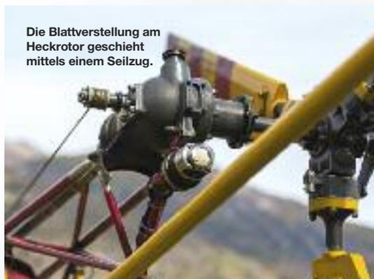
Die Blattverstellung am Heckrotor geschieht mittels einem Seilzug.
